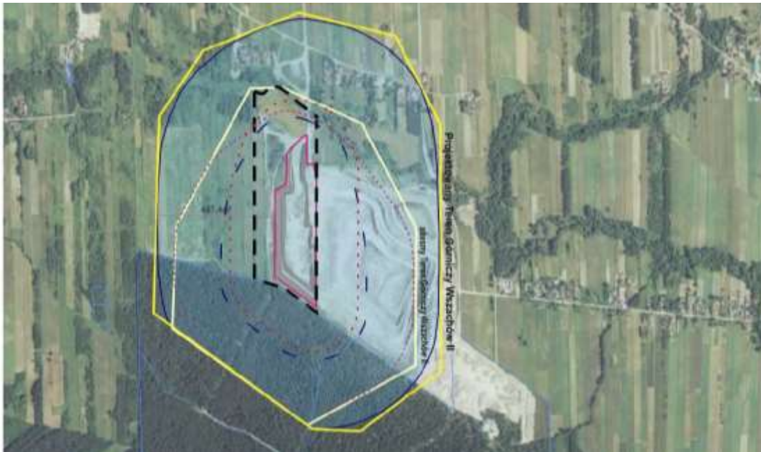
Rysunek 19. Zasięg leja depresji wraz z przewidywaną granicą Terenu Górniczego Wszachów IIB. Zasięg leja depresji kopalni Wszachów obrazuje rysunek poniżej [źródło: [2]]
